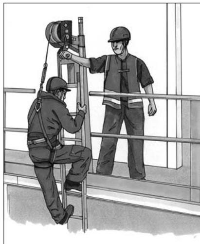
12 Accesso al silo tramite scala portatile. Permesso solo in combinazione con un dispositivo anticaduta di tipo retrattile con dispositivo di salvataggio.
