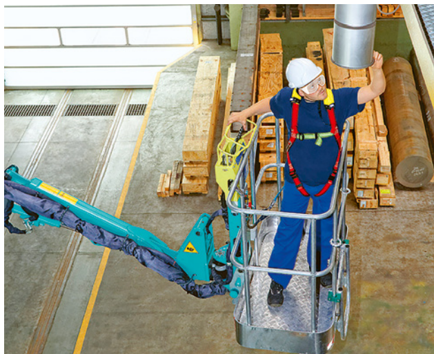
1 Piattaforma di lavoro elevabile per la sostituzione di lampade in altezza
