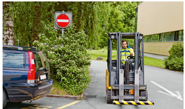
12 Forche munite di barre di protezione
