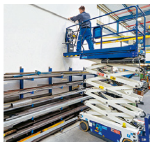
2 Piattaforma di lavoro elevabile per lavori di installazione e pulizia in altezza
