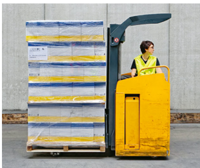
1 Messa in sicurezza del carico con pellicola estensibile
