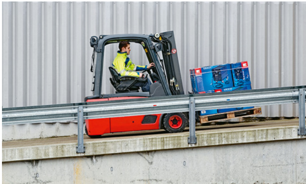
9 Trasportare il carico nel senso della salita.
