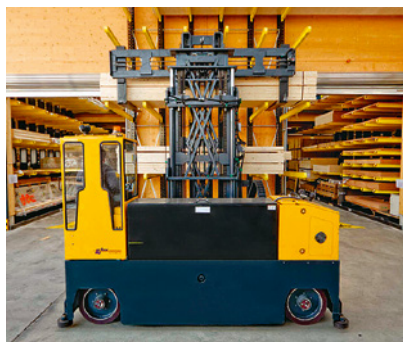
2 Carrello elevatore a forche laterali per il trasporto di merci lunghe
