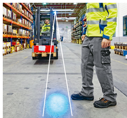
3 Dispositivo d'allarme ottico «punto blu».
