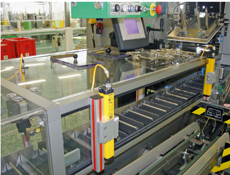
Wenn ein Mitarbeitender in den Bereich hinter den Lichtschranken greift, steht die Maschine sofort still.
