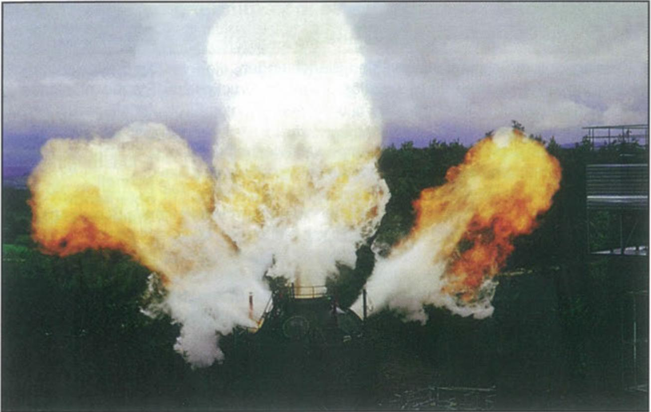
Abb. 17: Druckentlastung eines 250-m<sup>3</sup>-Behälters
