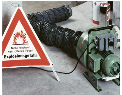
5 In Kellern ist eine künstliche Absaugung nötig. Bei Bedarf müssen tragbare Ventilatoren eingesetzt werden.
