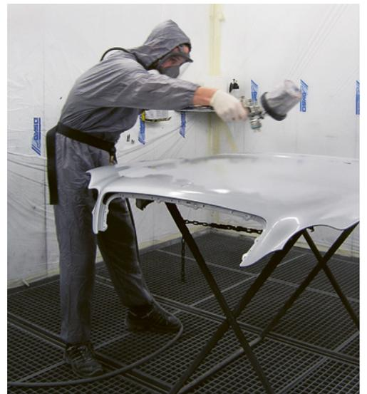
6 Beim Einsatz von 2K-Farben muss die Schutzstufe für die «Persönliche Schutzausrüstung» erhöht werden.
