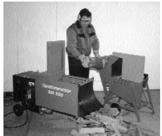
Bild 2: Horizontalspaltmaschine für Kurzholz mit verdeckter und verschlossener Spalteinrichtung.
