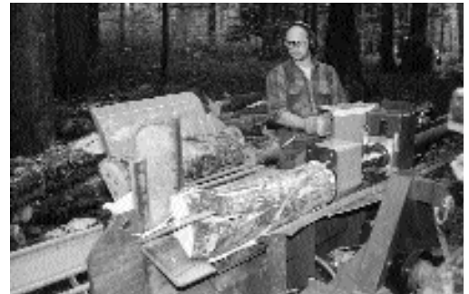
Bild 1: Holzspaltmaschine mit 2-Hand-Bedienung und Zuführvorrichtung für Meterholz. Das Holz muss nicht gehalten werden und die Bedienungsperson befindet sich an einem sicheren Standort.
