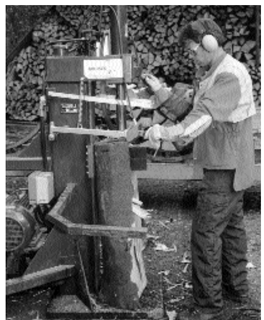
Bild 3: Vertikalspaltmaschine für Meterholz mit 2-Hand-Bedienung und Abstreifvorrichtung. Der Spaltkeil wird automatisch abgeschaltet, wenn die Abstreifvorrichtung durch ein verklemmtes Holzstück blockiert wird. Die Umwehrgung schützt vor umfallenden und weggeschleuderten Holzstücken.
