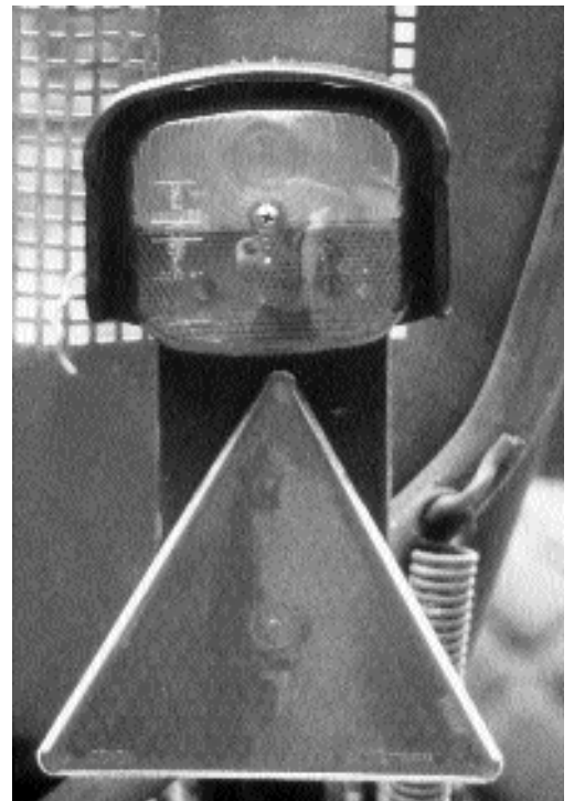
Bild 5: Balken mit reflektierendem Dreieckrückstrahler, Rückstrahler und Schlusslicht / Blinkanlage.
