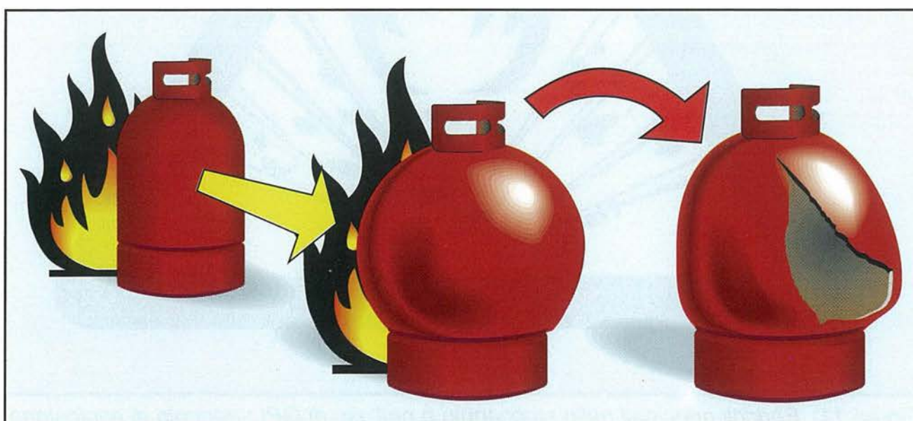
Figura 12: Effetto di un incendio su una bombola.
