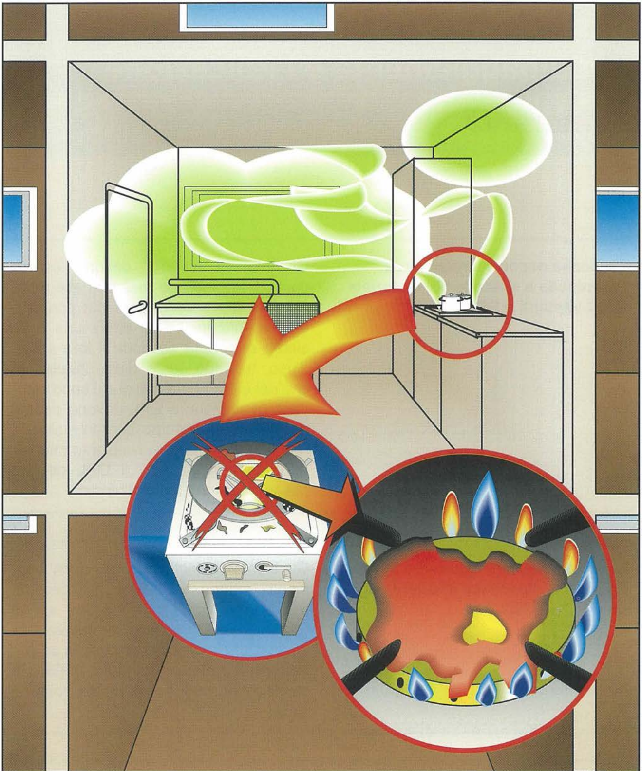
Figura 17: Formazione di monossido di carbonio dovuta a un fornello sporco.
