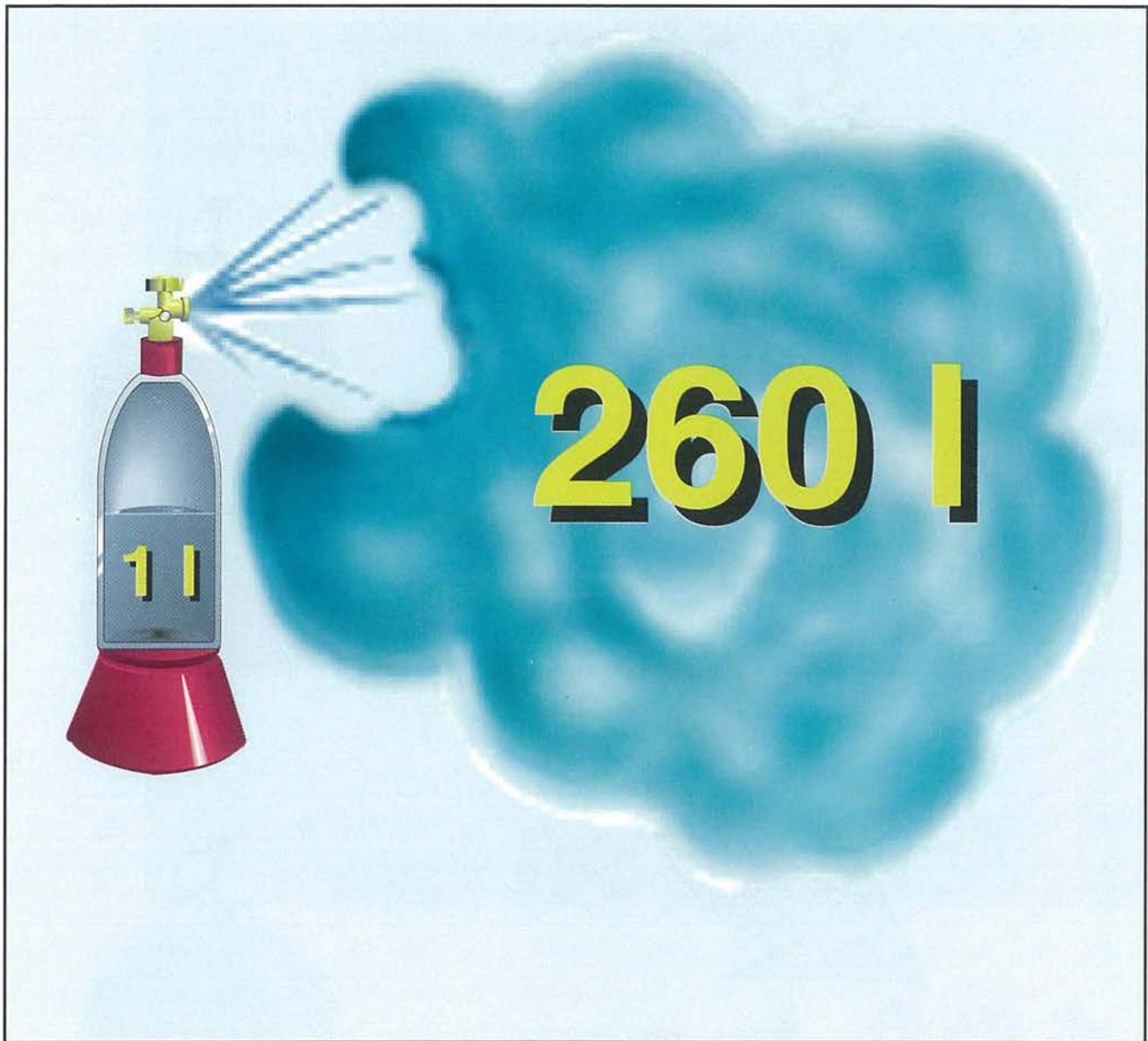
Figura 10: Aumento del volume all'atto dell'evaporazione del propano.
