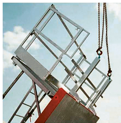
2 Bras de levage utilisé pour déplacer une unité complète.
