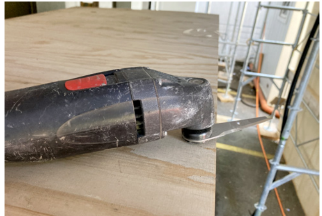
3 Elektro-Fugenschneider mit oszillierendem Messer.
