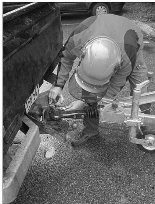
Bild 6: Kontrolle, ob der Anhänger korrekt am Zugfahrzeug angekoppelt ist.
