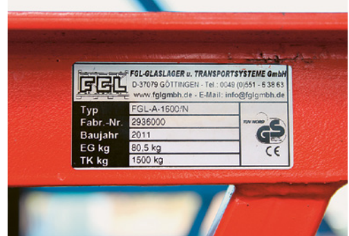
1 Typenschild mit den notwendigen Minimalangaben
