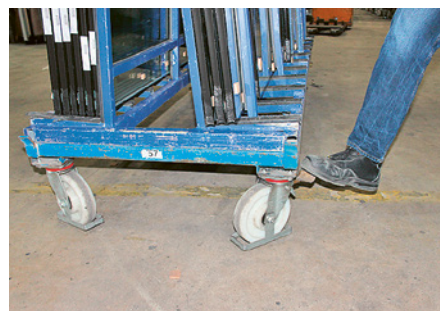
9 Feststellbremse an einem fahrbaren Gestell
