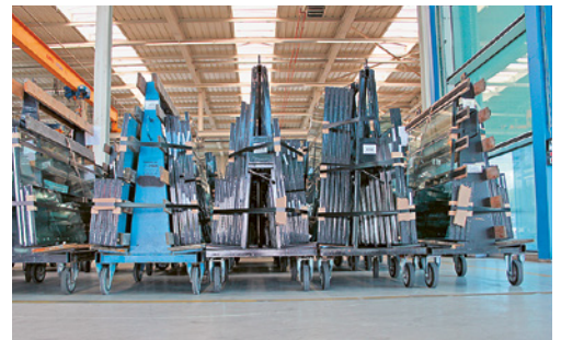
6 Gestelle immer gleichmässig beladen.
