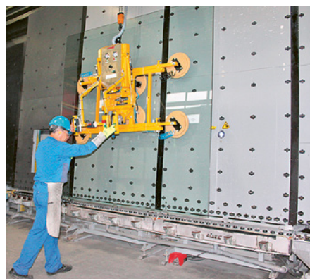
11 Vakuumheber im Einsatz
