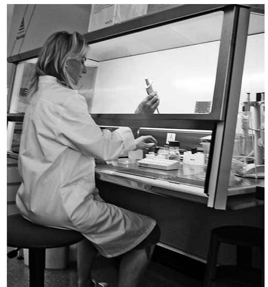
Fig. 1: protection contre la formation d'aérosols avec un poste de sécurité microbiologique.
