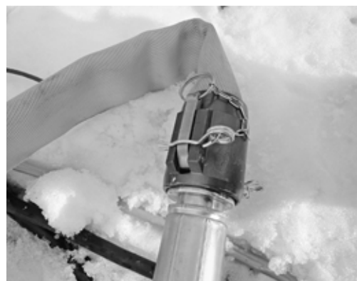
Fig. 1: le raccord Kamlok doit être sécurisé contre toute ouverture involontaire avec une goupille fendue.
