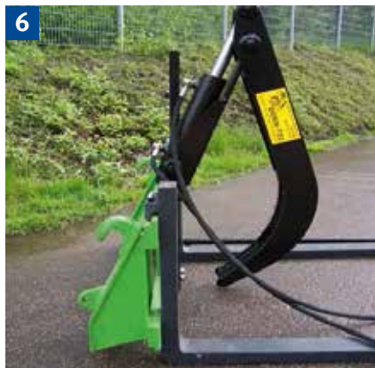
Gabelstapler mit Zangengreifer zum Transport von Rundholz.
