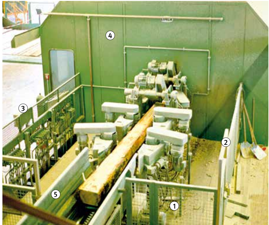
Bild 13: Übergang vom wannenartig gesicherten Blockzug zum umzäunten Gefahrbereich Einzugswerk Parallelzerspanner
