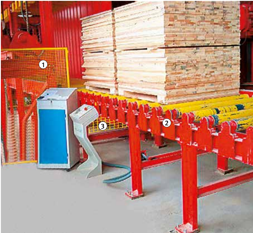
Bild 30: Ausführungsbeispiel Rollengang als Teil der Zugangssicherung zum Gefahrenbereich einer Stapelanlage
