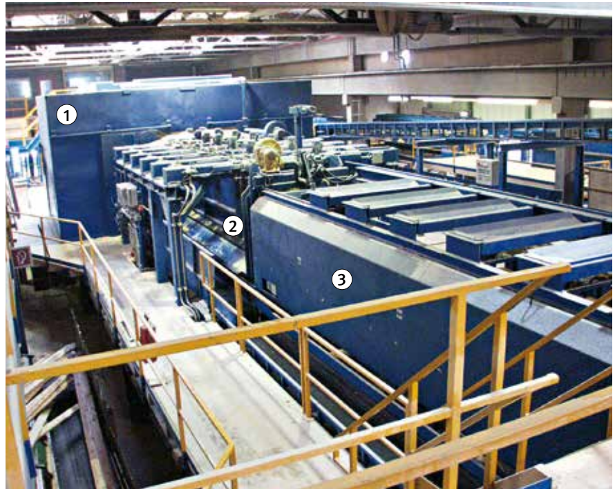
Bild 22: Mehrblattkreissägemaschine mit Seitenwarenabscheider
