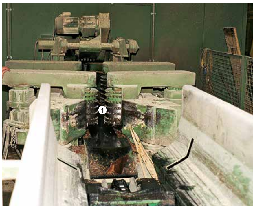
Bild 14: Geschlossenes Einzugswerk als Schutz gegen Herausschleudern von Werkstücken und Werkstückteilen
