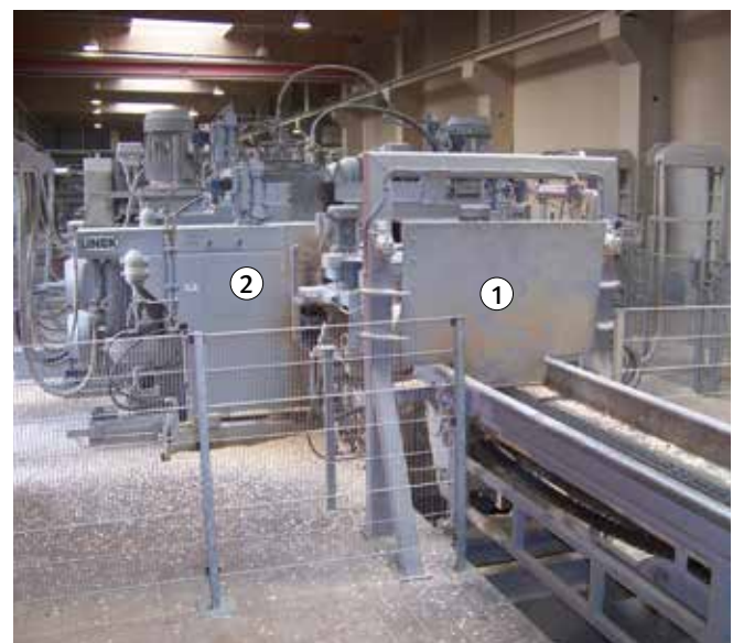
Bild 5: Einschwenkbare Rückschlag- sicherung vor der Einzugs- und Zentriereinrichtung des Säge- Fräsaggregates (Quelle Linck) 1. Rückschlagsicherung (Rückschlagklappe) 2. Säge-/Fräsaggregat
