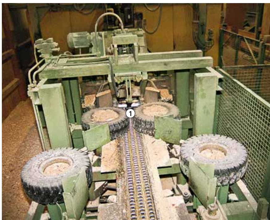
Bild 15: Geschlossenes Einzugswerk als Schutz gegen Herausschleudern von Werkstücken und Werkstückteilen
