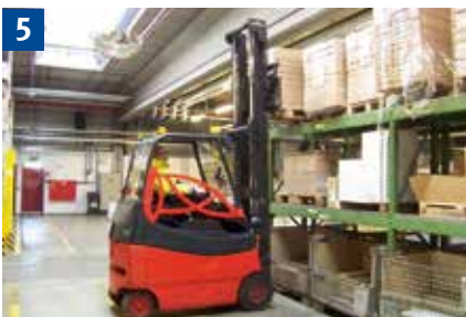
5 Mit hochgestellter Last nur zum Auf- und Absetzen verfahren. Hubgerüst nur über Stapelfläche nach vorn neigen.
