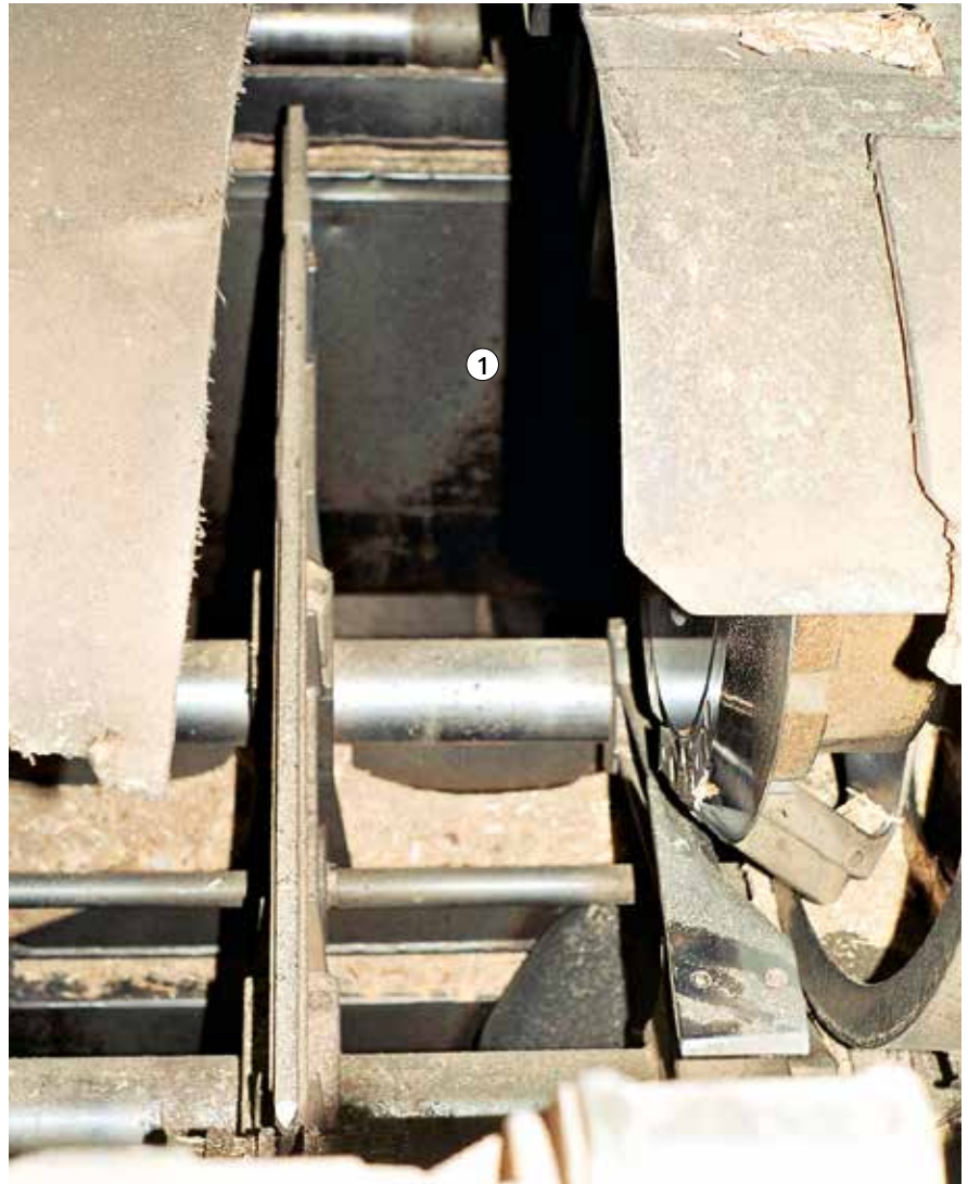
Bild 40: Fehlende Standfläche zum Werkzeugwechsel an einem Spaner
