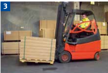
3 Last am Gabelrücken anlegen, Hubmast nach hinten neigen. Gabelzinken gleichmäßig belasten, in niedrigster Stellung verfahren.
