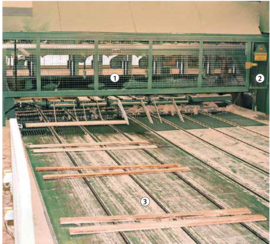
Bild 33: Ausführungsbeispiel Stetigförderer für Seitenwarenabtransport, um den Zugang zum Gefahrenbereich einer Mehrblattkreissäge zu verhindern
