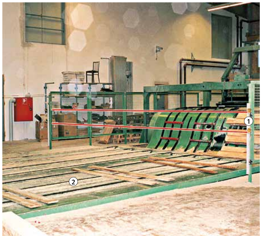
Bild 29: Ausführungsbeispiel Stetigförderer für Seitenware zwischen Einschnittlinie und Besäumanlage
