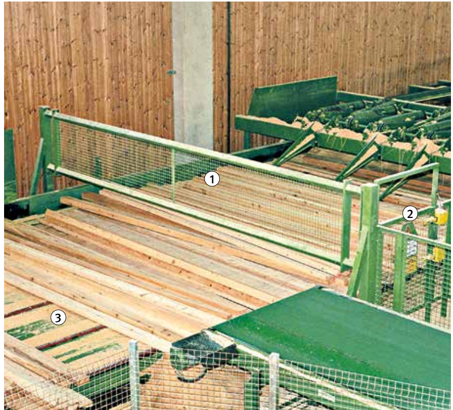
Bild 28: Ausführungsbeispiel Stetigförderer für Seitenwarenabtransport, um den Zugang zum Gefahrenbereich der Einschnittlinie zu verhindern
