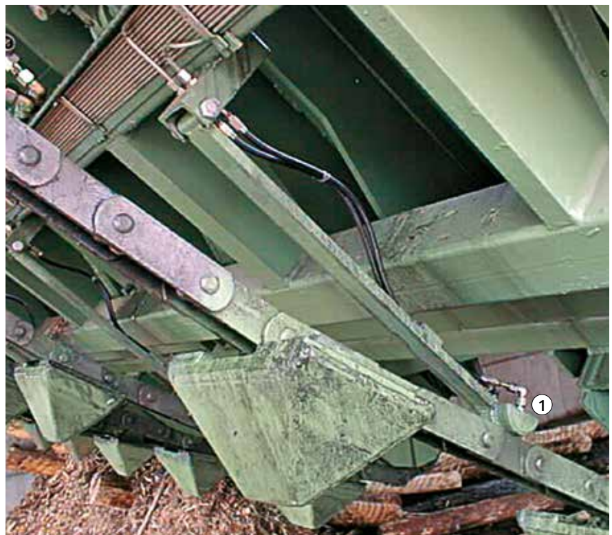
Bild 34: Zentralschmierung am rücklaufenden Kettenstrang eines Vereinzelners
