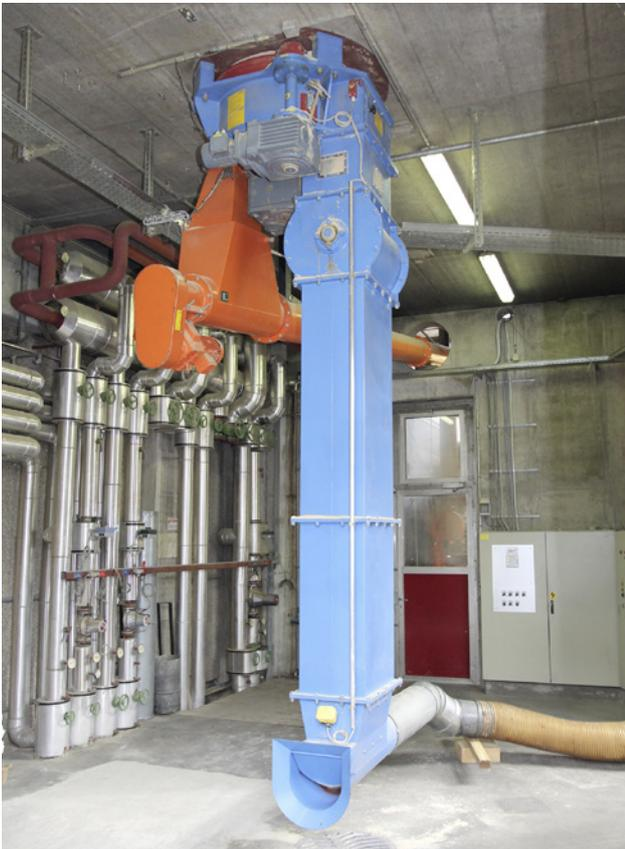
23 Absaugen von Holzspänen mit Saugfahrzeug, bei laufendem Betrieb über den zweiten Ausfallschacht (blau) – (Quelle: Toma Holz AG)
