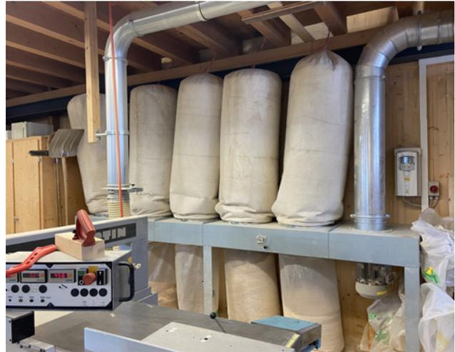
15 Alter Entstauber mit im Rohluftbereich angeordnetem Ventilator (Quelle: Suva).
