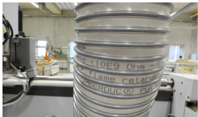
17 Schlauch antistatisch, schwer entflammbar (PUR). (Quelle: von Rohr Holzbau AG)
