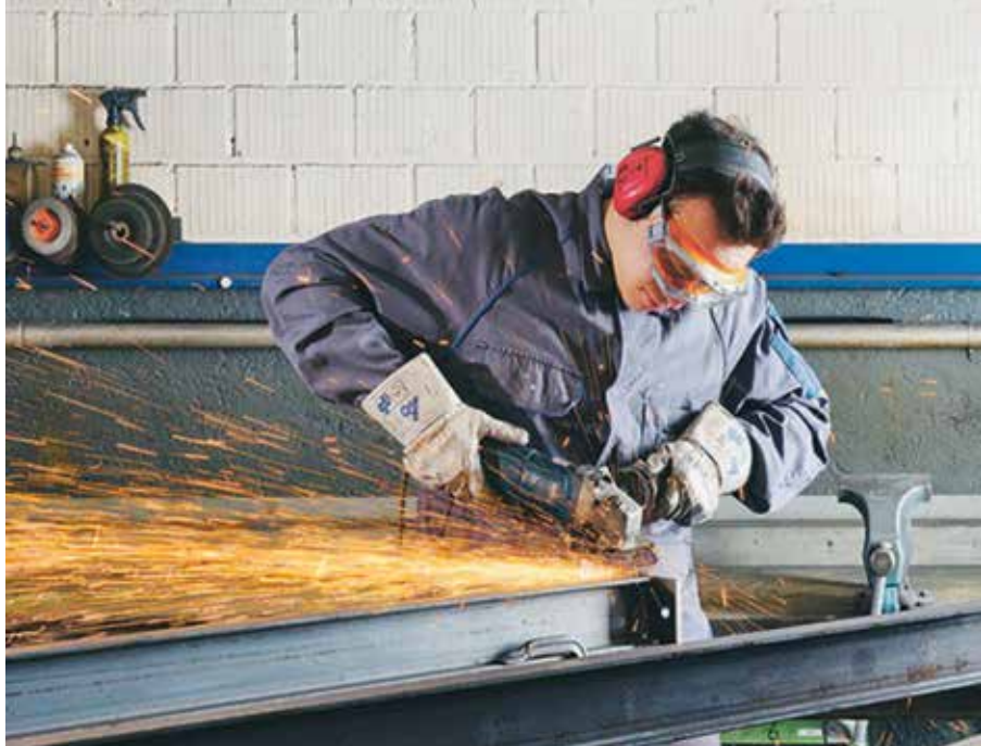
Schutz vor Lärm, Funken und wegfliegenden Metallspänen beim Schleifen.
