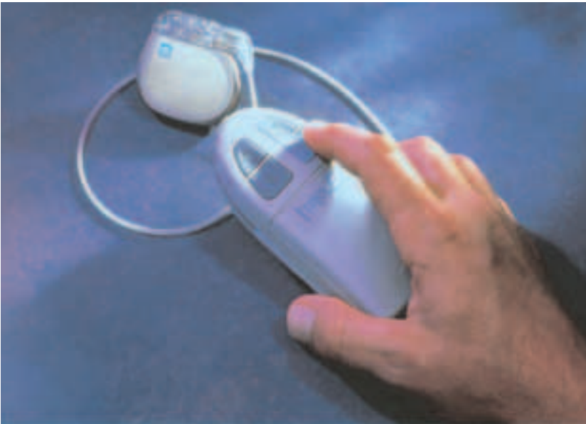
Abbildung 9 Impulsgeber und externes Programmiergerät für Patienten.
