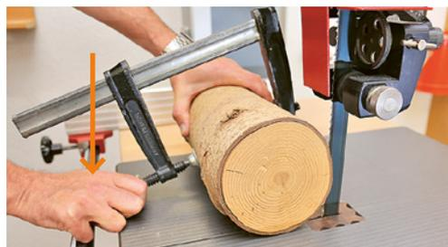
7 Lavorazione di ceppi. Applicando una morsa che spinge sul piano di lavoro si crea un secondo punto di appoggio.
