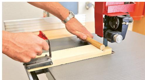
6 Lavorazione di bacchette tonde. La guarnizione in legno riduce il pericolo che possano rotolare via.
