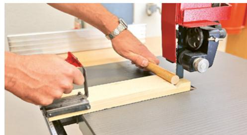
5 Lavorazione di bacchette tonde. L'ausilio in legno riduce il pericolo che possano ruotare.
