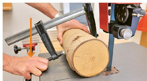
6 Lavorazione di ceppi. Applicando una morsa che spinge sul piano di lavoro si crea un secondo punto di appoggio.
