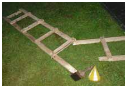
02 // Echelle de couvreur bricolée par le peintre ayant subi l'accident.
