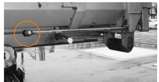
5 Öffnen der Hecktüren von einem sicheren Standort auf der Seite.
