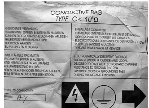
Bild 1: Die Kennzeichnung gibt Hinweise auf Zulassung und korrekte Verwendung.
