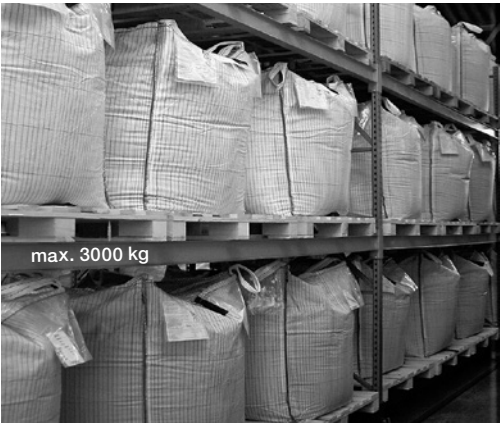
Bild 7: Die Gebinde sind einlagig oder in für Big Bags konstruierten Gestellen zu lagern.
