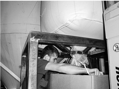
Bild 5: An der mechanisch abgestützten Entleerstation ist das Öffnen des Big Bags gefahrlos möglich.
