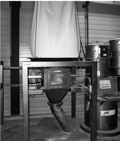
Bild 4: Entleerstation mit mechanischer Abstützung
