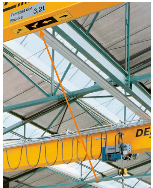
4 Le pont roulant doit être doté de symboles correspondant aux mouvements de la télécommande.
