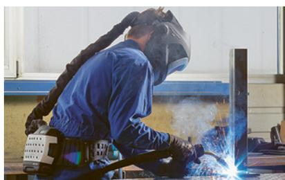
1 Casco protettivo con respiratore a ventilazione assistita
