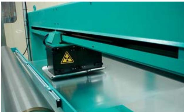
3 Sources radioactives pour la mesure d'épaisseurs.
