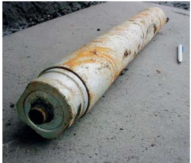
11 Sonde avec une source radioactive pour la mesure d'humidité.
