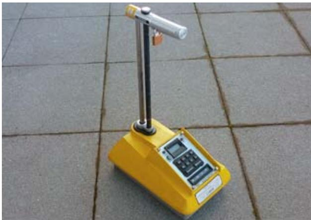
2 Sonde de mesure des sols pour la mesure de densité et d'humidité du bitume ou du goudron.
