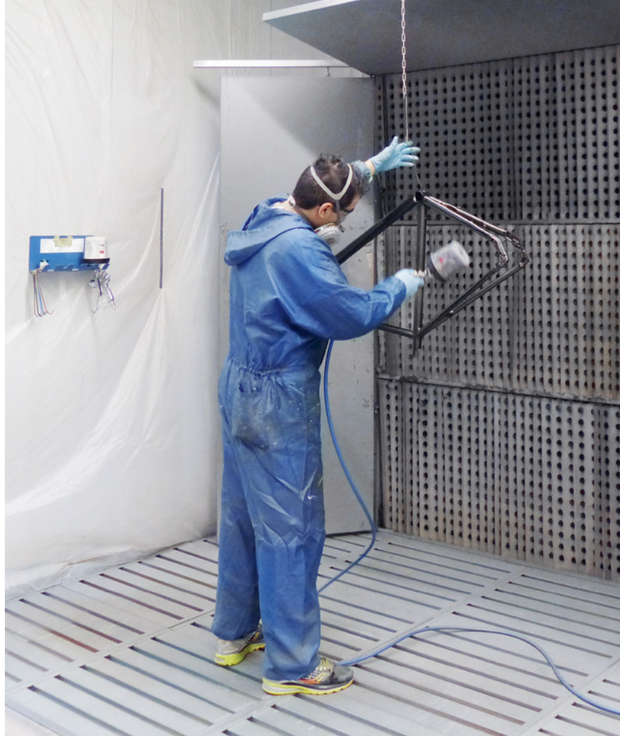
Des dispositifs d'évacuation bien placés permettent de prévenir la propagation des substances dangereuses.
