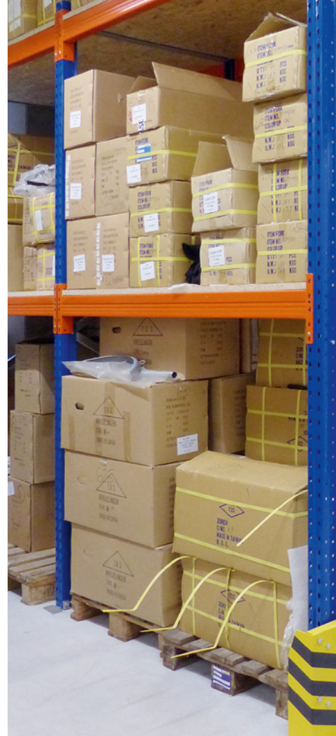
Une protection contre les heurts sécurise les étagères contre les dommages.
