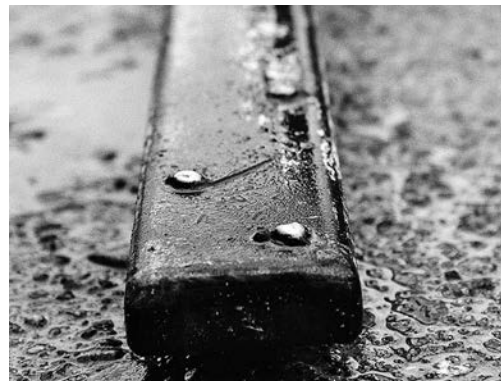
3 Une protection simple mais efficace contre les glissements a été montée après coup sur cette fourche.
