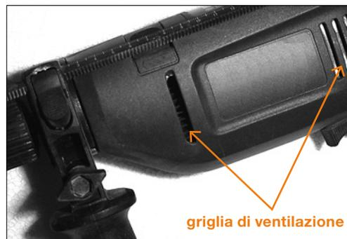
1 La griglia di ventilazione deve essere libera per impedire il surriscaldamento del motore elettrico.
