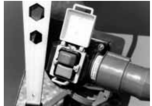
Als Sicherung gegen unbeabsichtigtes Einschalten kommt zum Beispiel ein versenkter oder verdeckter Einschalttaster in Frage.
