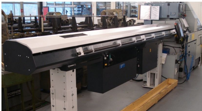
1 Embarreur à rampe de chargement latérale
