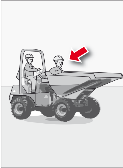
☹ Falsch – Faux – Sbagliato 59
