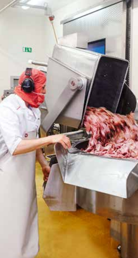
Phase de remplissage d'un cutter
