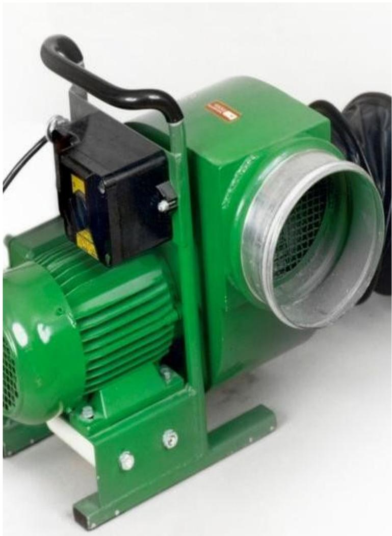
Dans les locaux exigus, nous empêchons les explosions et les intoxications au moyen d'un ventilateur d'extraction.
