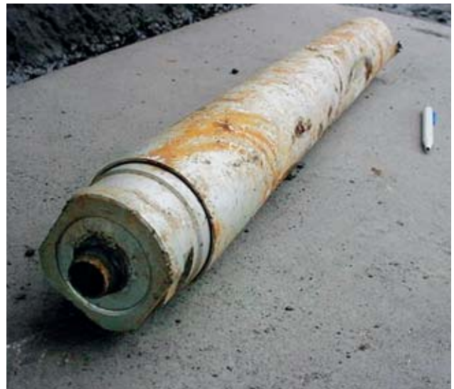
11 Sonde mit radioaktiver Quelle für die Feuchtigkeitsmessung.
