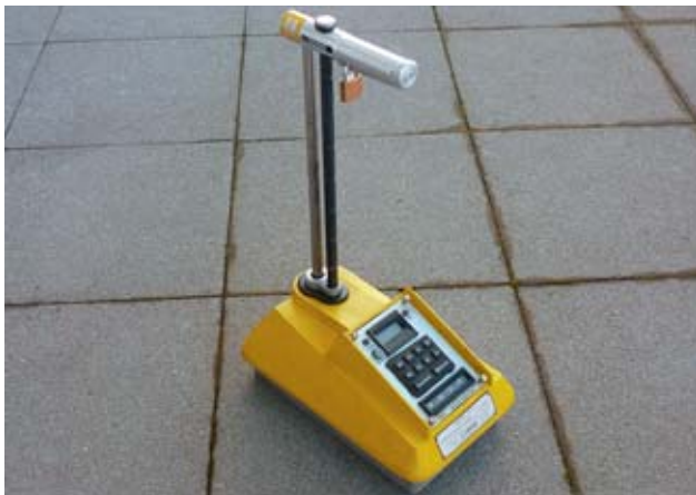
2 Bodenmesssonde für die Dichte- und Feuchtigkeitsmessung von Teer oder Asphalt
