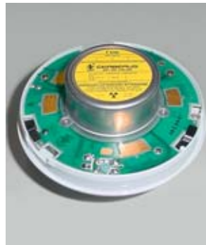
4 Rauchmelder der früheren Generation können eine radioaktive Quelle enthalten. Man nennt sie Ionisationsrauchmelder.
