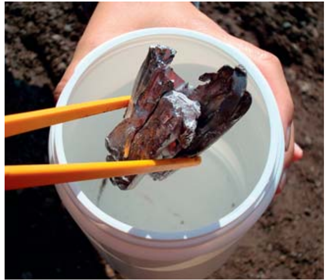
10 Teile eines Ionisators. Solche Einrichtungen wurden für die Ableitung statischer Ladungen eingesetzt.
