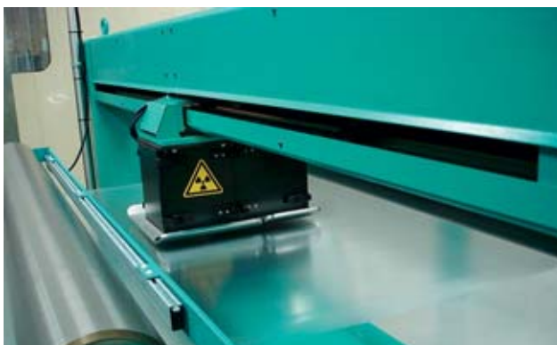
3 Radioaktive Strahlenquelle für die Schichtdickenmessung
