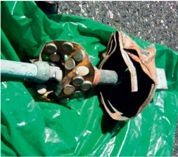
8 Blitzableiter aus den 70er Jahren. Er enthält radioaktive Strahlenquellen.
