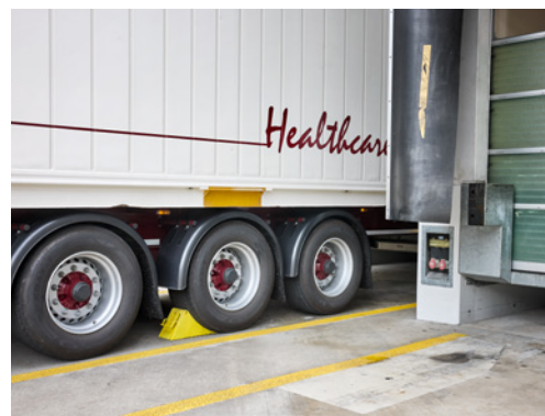
7 Avec une cale sous la roue, le personnel de chargement est certain que le véhicule ne risque pas d'avancer.
