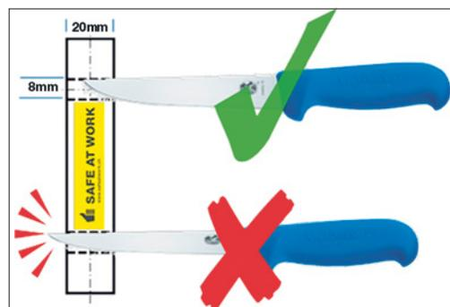
Image 3: contrôle de la lame avec un calibre pour couteaux
