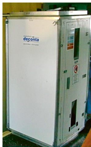
2 Eingang zur Sanierungszone (Schleuse, abgedichtet)
