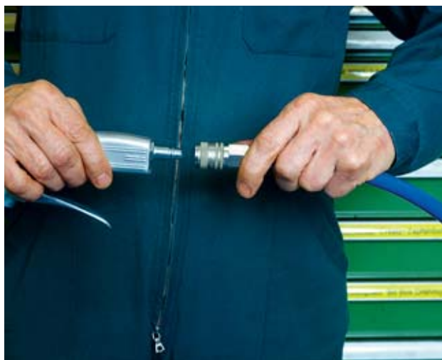
Figura 6: utilizzare raccordi di sicurezza.
