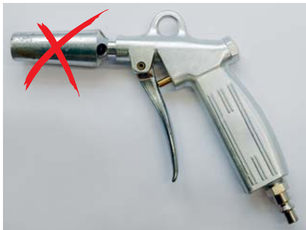
Figura 2: l'uso di pistole ad aria compressa con ugelli Venturi non è consentito.
