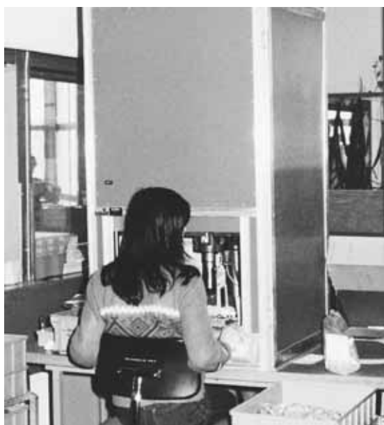
Bild 22: Gekapselte Ultraschallschweissmaschine (Türe der Kapselung geschlossen).
