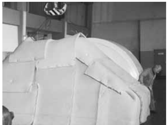
Bild 40: Schallschutzhaube für eine Peltonturbine, Versuchsaufbau.
