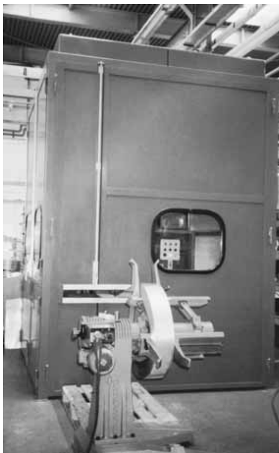
Bild 32: Kapselung eines Stanzautomaten (im Vordergrund ist der Haspel für die Blechbandzuführung zu erkennen).
