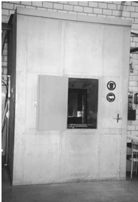
Bild 42: Kapselung der Einwurfseite bei einer Mühle für Kunststoffrohre.
