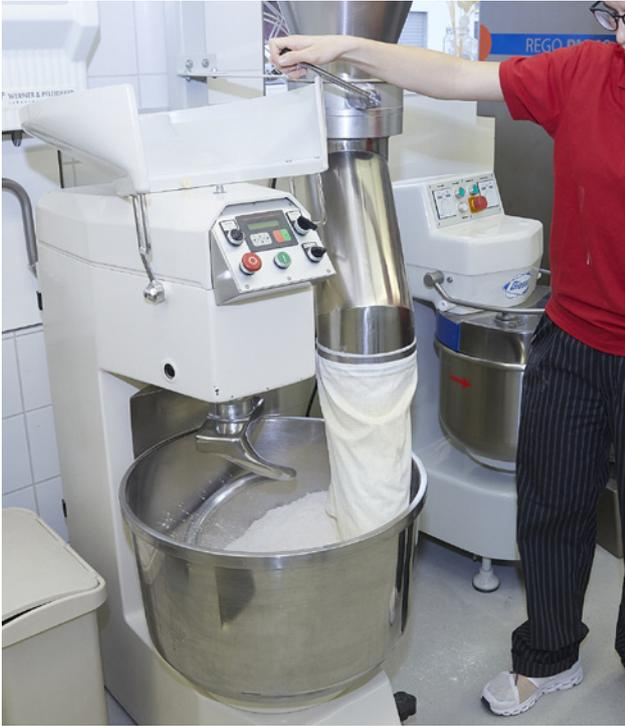
1. Amener le tuyau de remplissage de la balance à farine presque jusqu'au fond du pétrin.
