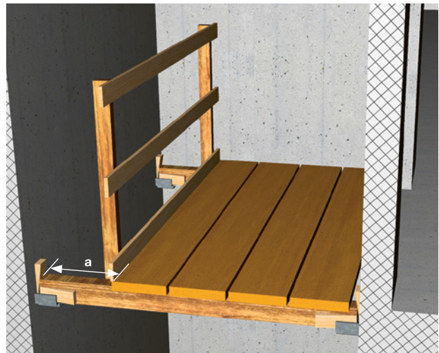
6 Bei einem Abstand [a] von mehr als 30 cm verhindert ein 3-teiliger Seitenschutz den Absturz.
