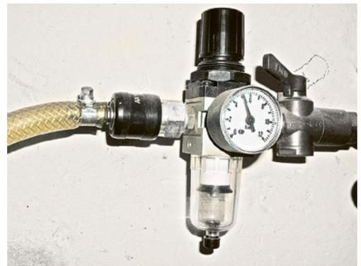
6 Druckluftminderer mit eingebautem Sicherheitsventil
