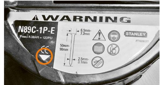
**1** Nagelpistolen mit einer Auslösesicherung sind mit einem auf dem Kopf stehenden Dreieck gekennzeichnet.
