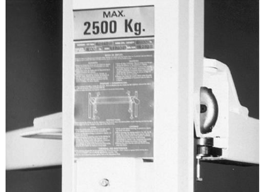
**1** Die Tragkraft muss gut sichtbar angeschrieben sein.
