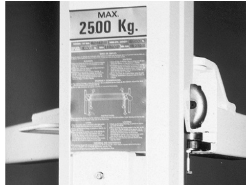
1 Die Tragkraft muss gut sichtbar angeschrieben sein.
