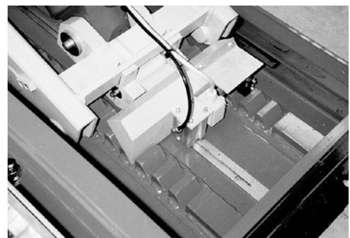
3 Klinkensicherung gegen ungewolltes Absenken
