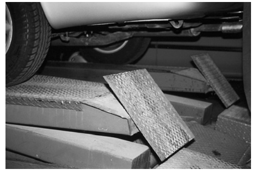
4 Abfallsicherung, die beim Anheben der Hebebühne automatisch wirksam wird
