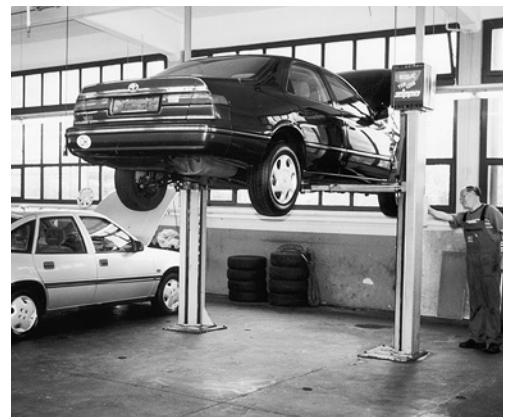
2 Hier besteht beim Bedienen eine gute Übersicht und keine Einklemmgefahr.
