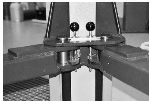
5 Sicherung gegen Ausschwenken der Tragarme
