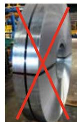
Fig. 2 Ne jamais entreposer des bobines de feuillard d'acier sans support.
