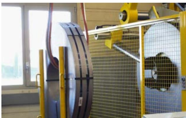
Fig. 6 Lors du transport par pont roulant à l'aide de sangles de levage, il faut utiliser des sangles à bordures renforcées.
