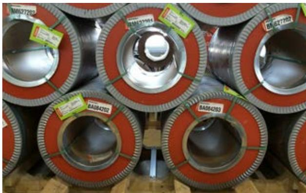
Fig. 1 Le système de berceau permet d'empiler plusieurs niveaux de bobines en toute sécurité.
