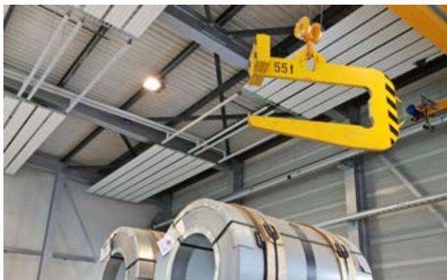
Fig. 5 Pour transporter des bobines de grande dimension avec l'axe à l'horizontale au moyen d'un pont roulant, il est possible d'utiliser par ex. un cé de retournement à contrepoids.
