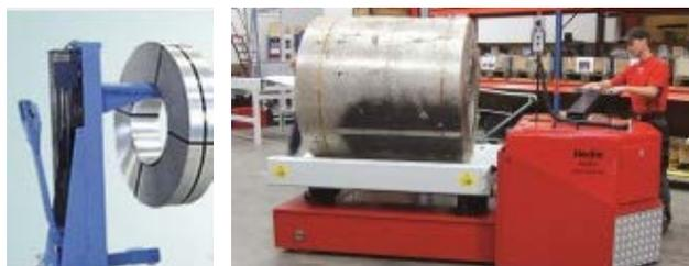
Fig. 7 et 8 Divers types de chariots porte-bobines permettent de transporter en toute sécurité des bobines de feuillard et des coils avec l'axe à l'horizontale.
