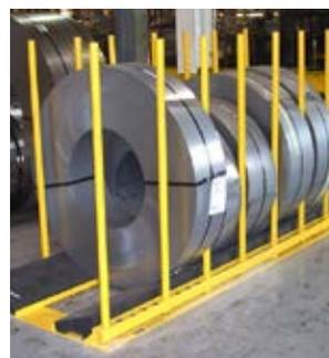
Fig. 3 Le support empêche le basculement des bobines de feuillard.
