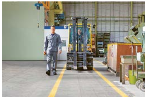
3 Signalisation de la voie de circulation et délimitation de la zone de stockage.
