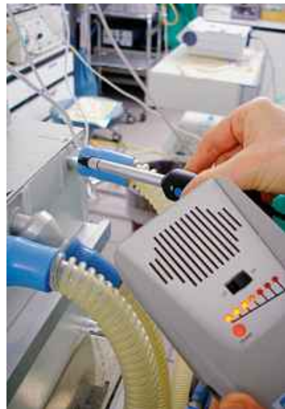
Gaz d'anesthésie: mesure des fuites dans la salle d'opération.
