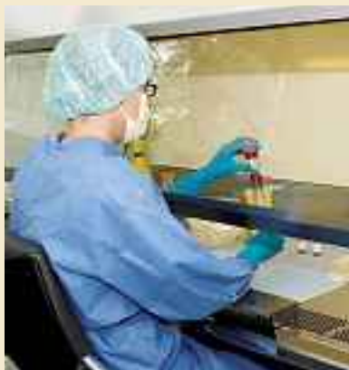
Préparation de cytostatiques dans un poste de sécurité biologique de classe II
