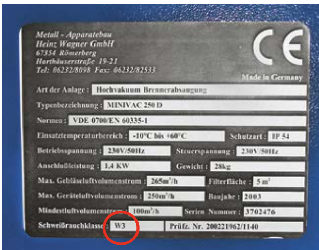
Bild 2 Typenschild einer Brennerabsaugung mit der Schweißrauchabscheideklasse W3
