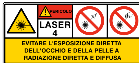
1 Classificazione, segnale di avvertimento «Laser di classe 4» e targhetta informativa ai sensi della norma SN EN 60825-1
