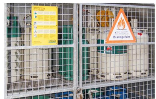
Figura 8: bombole di gas stoccate in modo corretto
