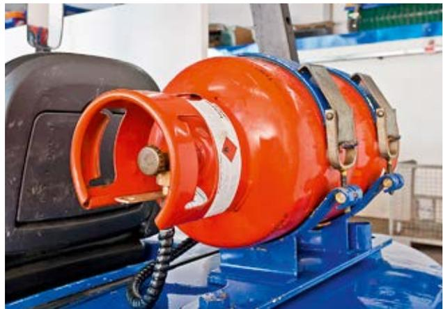
1 Chariot élévateur avec bouteille à tube plongeur: le collier protège la vanne de prélèvement contre les dommages mécaniques.
